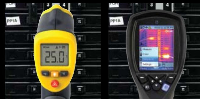
点温仪, 测量一个点的温度。
